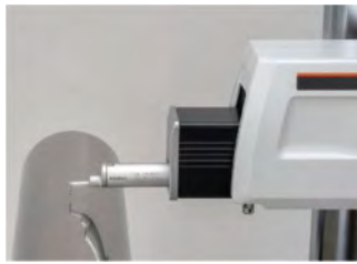
轻松测量R面粗糙度(无轨测量时)
