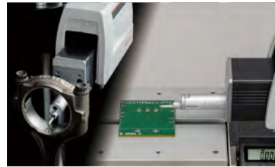
测量表面粗糙度,还可测量轮廓形状(细微轮廓)
